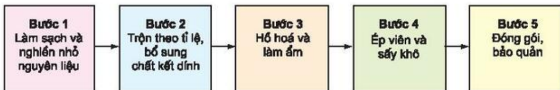
Hình 31.4. Quy trình sản xuất thức ăn hỗn hợp nuôi thủy sản
