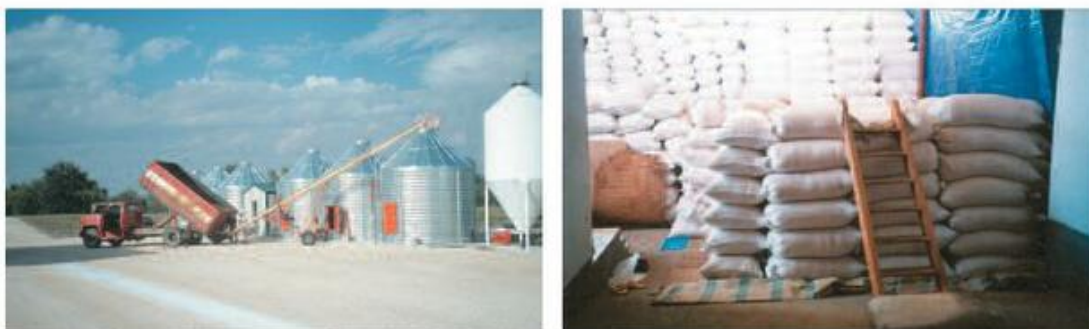
Hình 40.1. Bảo quản nông sản trong kho a) Kho silô ; b) Kho thông thường
