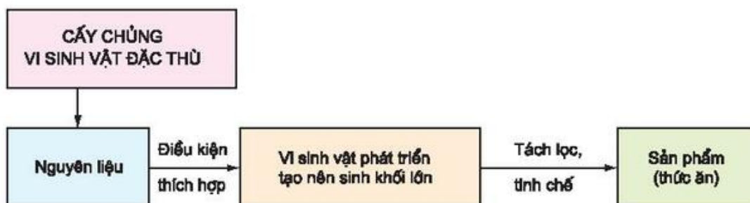
Hình 33.2. Quy trình sản xuất thức ăn từ vi sinh vật
